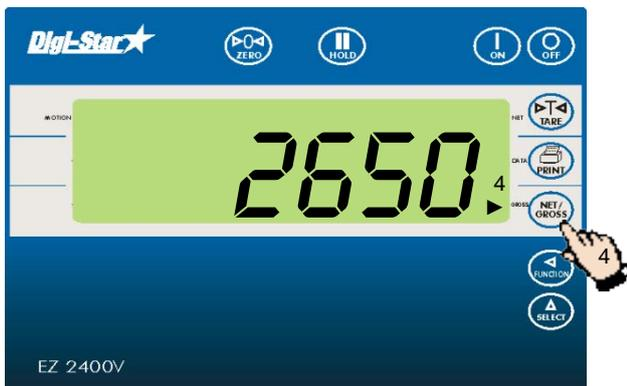
4. Drücken Sie auf **NET/GROSS**, um die gesamte geladene Produktmenge anzuzeigen. In diesem Beispiel:  $2350 \text{ kg} + 300 \text{ kg} = 2650 \text{ kg}$ . Rechts unten auf dem Display blinkt ein Pfeil bei GROSS (Bruttogewicht).
