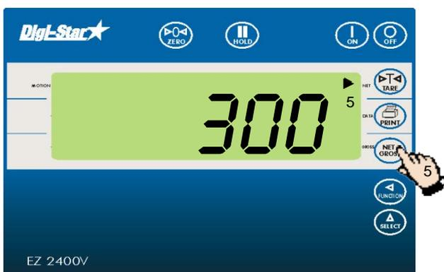
5. Drücken Sie noch einmal auf **NET/GROSS**, um zum Nettomodus zurückzukehren. Rechts oben auf dem Display blinkt ein Pfeil bei NET (Nettogewicht).
